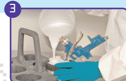
3 Benutzen Sie den Farbmixbecher, um die benötigte Lackmenge vorsichtig in die Einfüllöffnung zu gießen.
