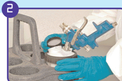
2 Sichern Sie den rPPS Becher, indem Sie die Pistole halten oder ein PPS Tragegestell nutzen und entfernen Sie den Verschlussdeckel.
