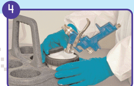
4 Drehen Sie den Deckel wieder zu und schließen Sie die Pistole wieder an die Druckluft an.
